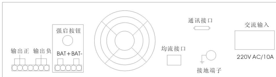
图 7 SOC-P4820/1000 电源箱背面板示意图
